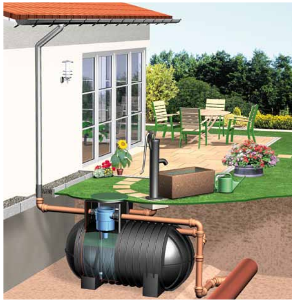
Regenwassernutzung durch unterirdische Speicherstation
