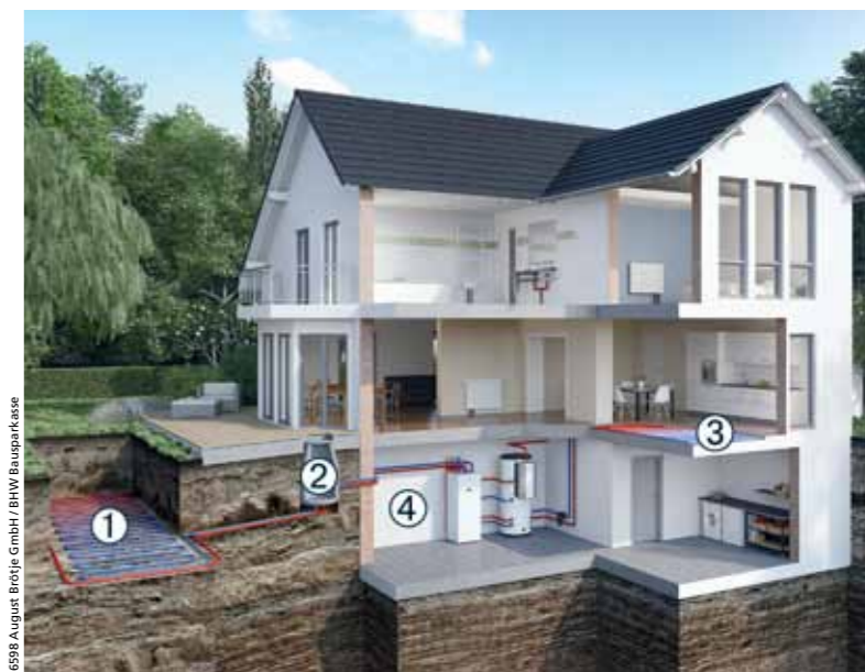
Heizen per Erdwärme: ① Erdkollektoren ② Verteil- und Sammelstation ③ Fußbodenheizung ④ Wärmepumpen
