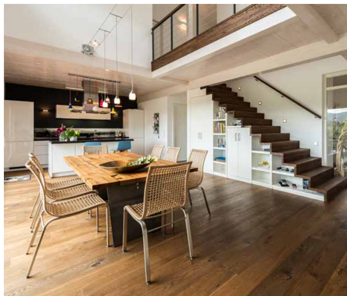
Die Decke besteht aus lasierter Fichte, Boden und Treppe sind aus Eiche
